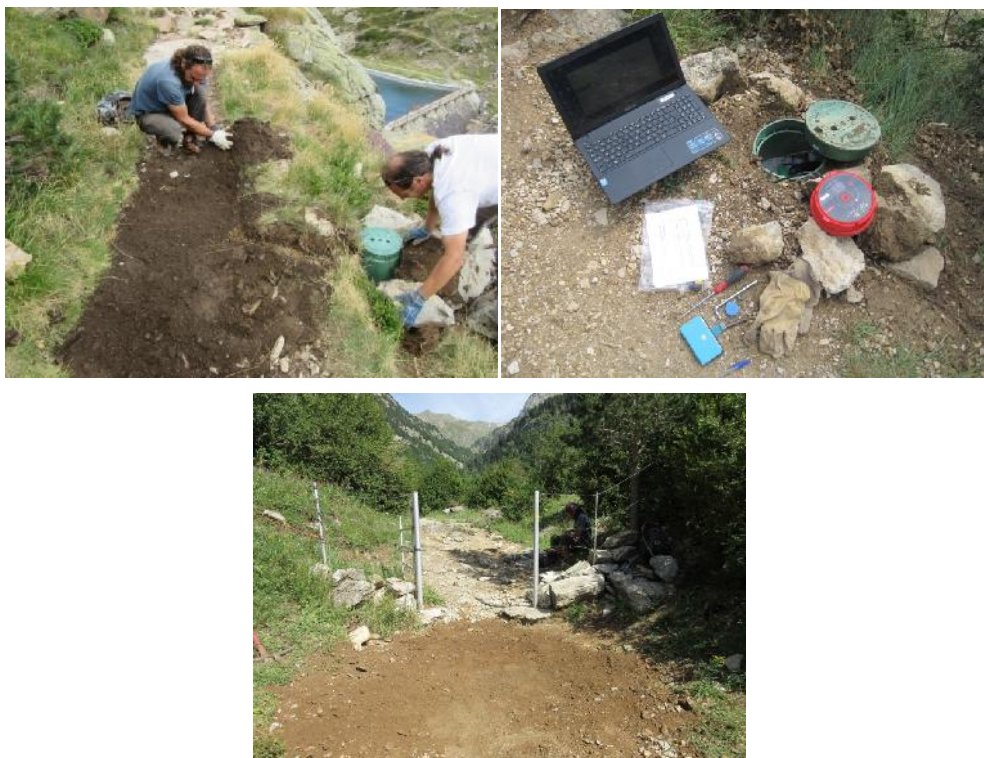
Fotos de detalle del eco-contador durante su colocación y posteriormente.
